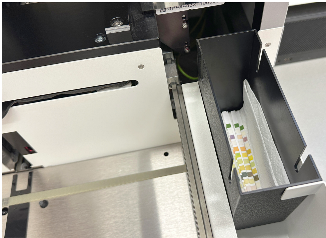
Ubrousek v odpadní nádobce Labumatu napomáhá snadnějšímu vysypávání vlhkých proužků.
