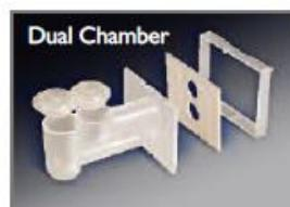
Možnost umístění dvou vzorků na jedno sklíčko z důvodu zvýšení efektivity a úspory.
